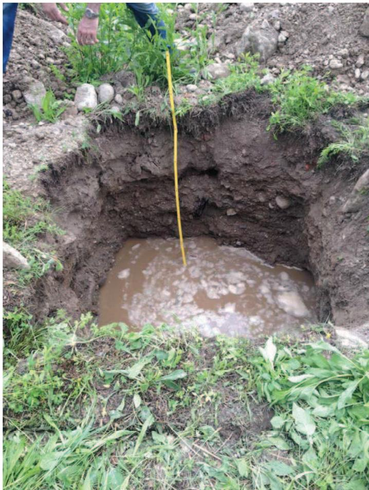
Foto 8: Prova di permeabilità
