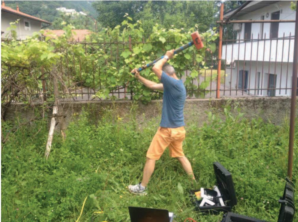
Foto 5-6-7: Analisi sismica (metodo MASW)
